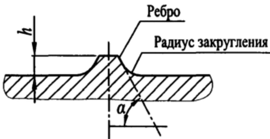
Рисунок 2 - Поперечное сечение ребра (сечение А-А из рисунка 1)
